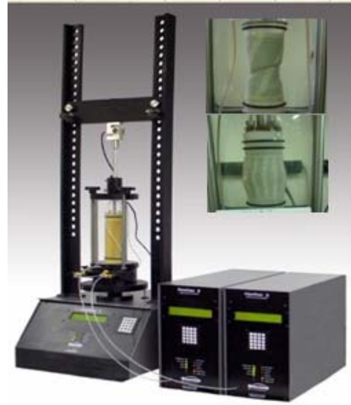
Hình 1: Thiết bị thí nghiệm Ba trục tự động
